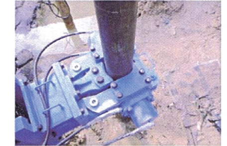
開閉部のはまり込みの凸凹形状を変更。 リーダ側のガイド厚を増すことでパイプ ガイドの摩擦による芯ずれを軽減。
