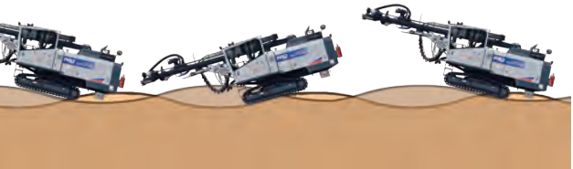
オシレーティング機能無し: 路面の凹凸により不安定な走行に
