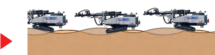
オシレーティング機能有り: 左右の履帯が接地し安定した走行が可能
